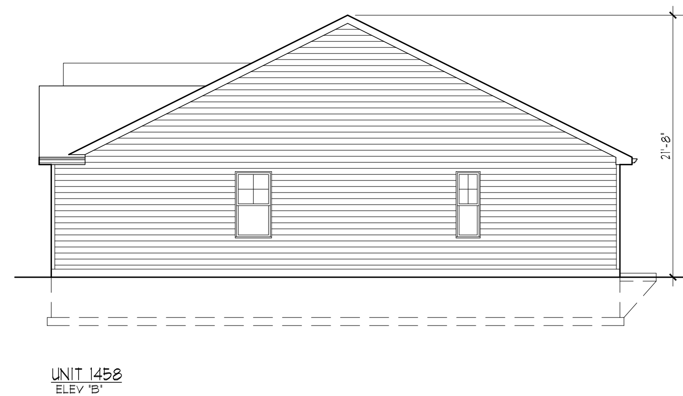
RIGHT ELEV DUPLEX TYPE 2 (SLAB) (1458/A-1458/B) SCALE: 1/8" = 1'-0"
