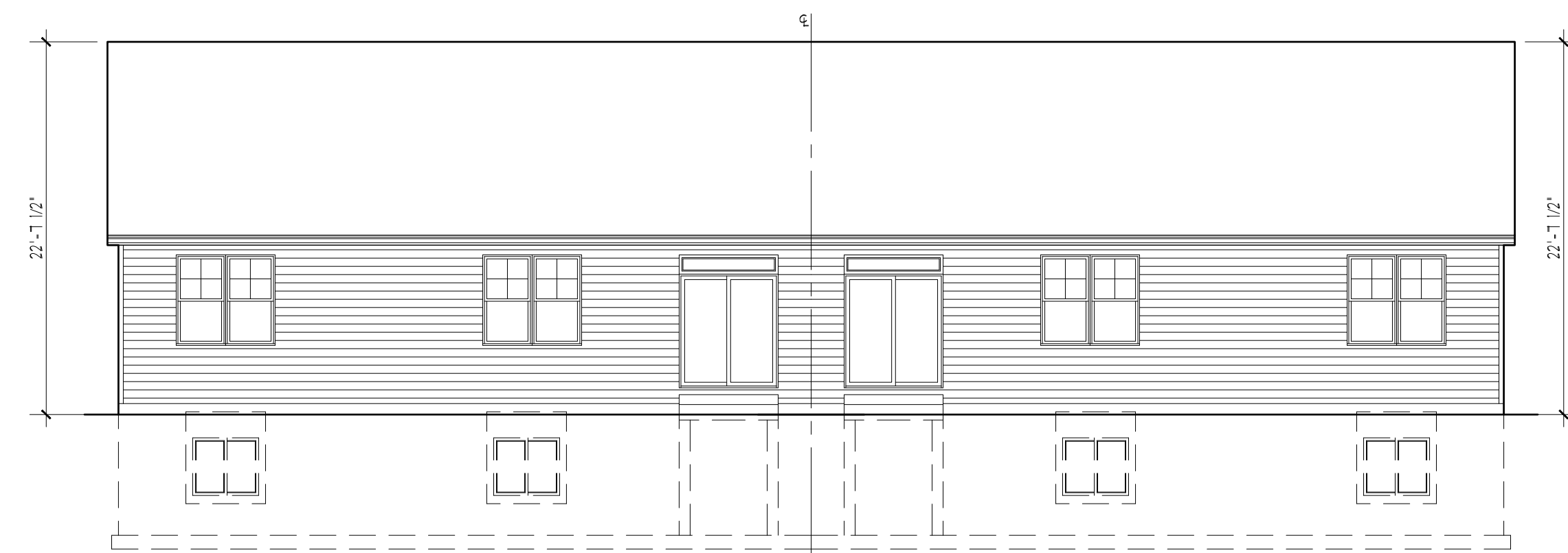
UNIT 1458 ELEV 'B' REAR ELEVATION SCALE: 1/8" = 1'-0"
