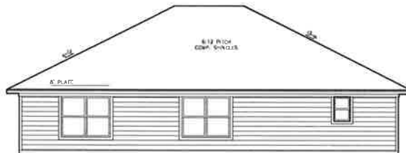
REAR ELEVATION SCALE: 1/8" = 1'-0"
