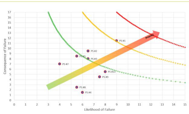
FIGURE 4-2: PUMP STATION RISK OF FAILURE ANALYSIS
