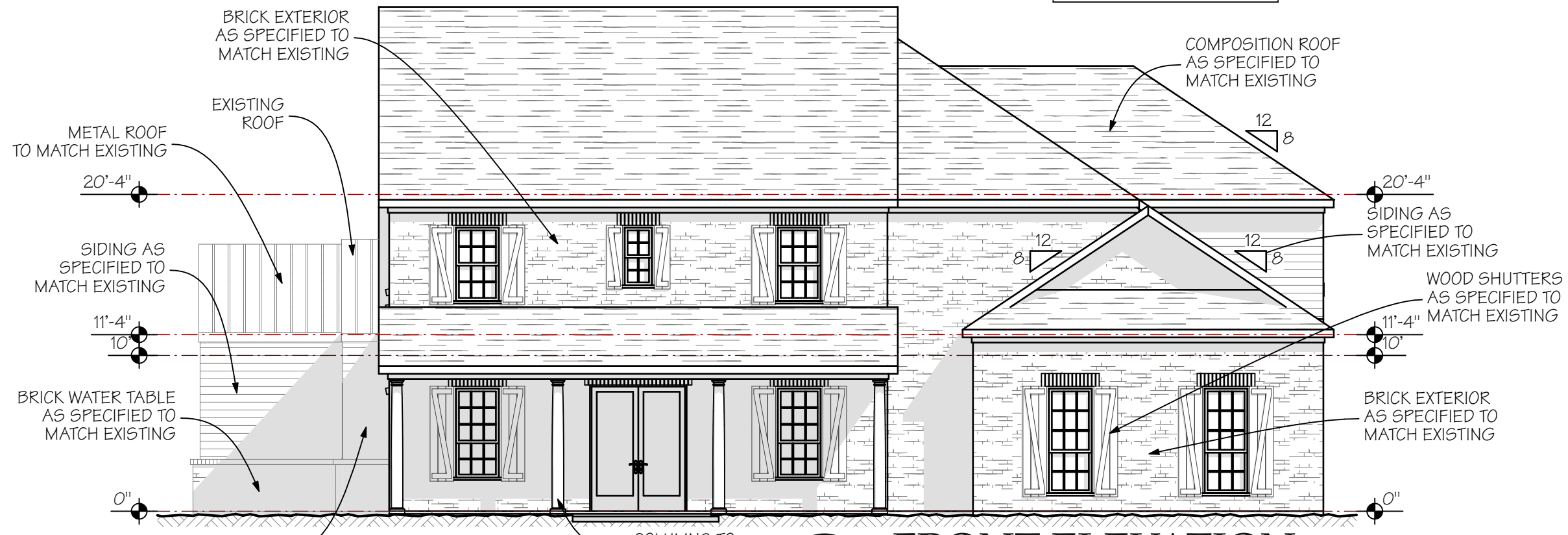
1 FRONT ELEVATION SCALE: 1/8" = 1'-0"
