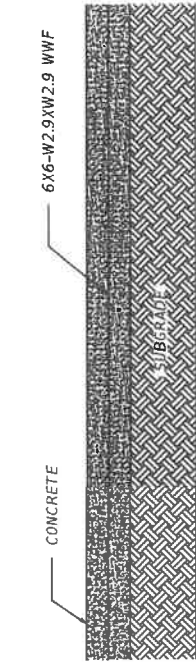
MS31 CONCRETE PAVEMENT DESIGN SCALE: N.T.S
