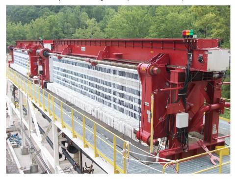
Figure 5-8. Plate filter press
