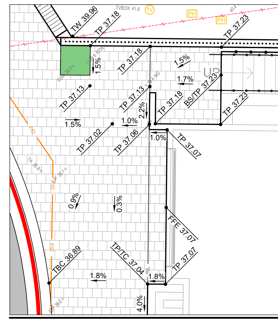
GRADING DETAIL "A" SCALE: 1" = 5'
