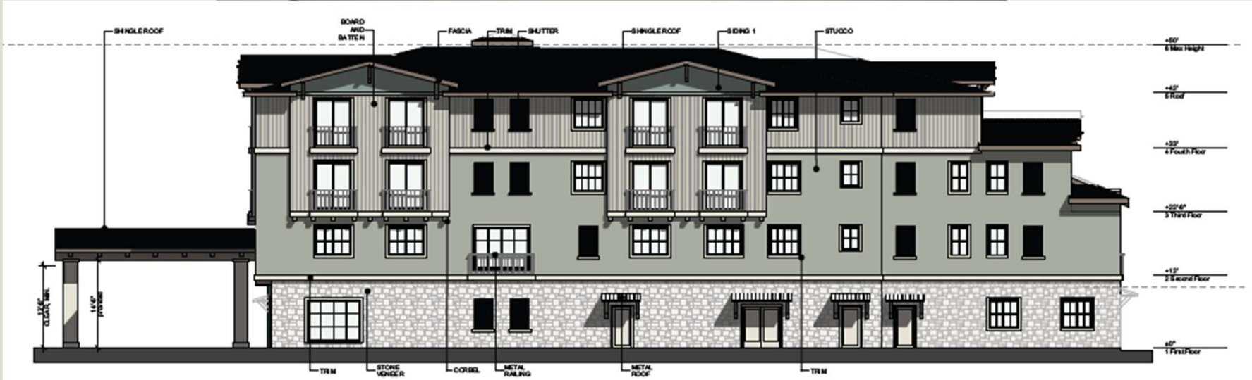
Right Elevation - East SCALE: 1/8" = 1'-0"
