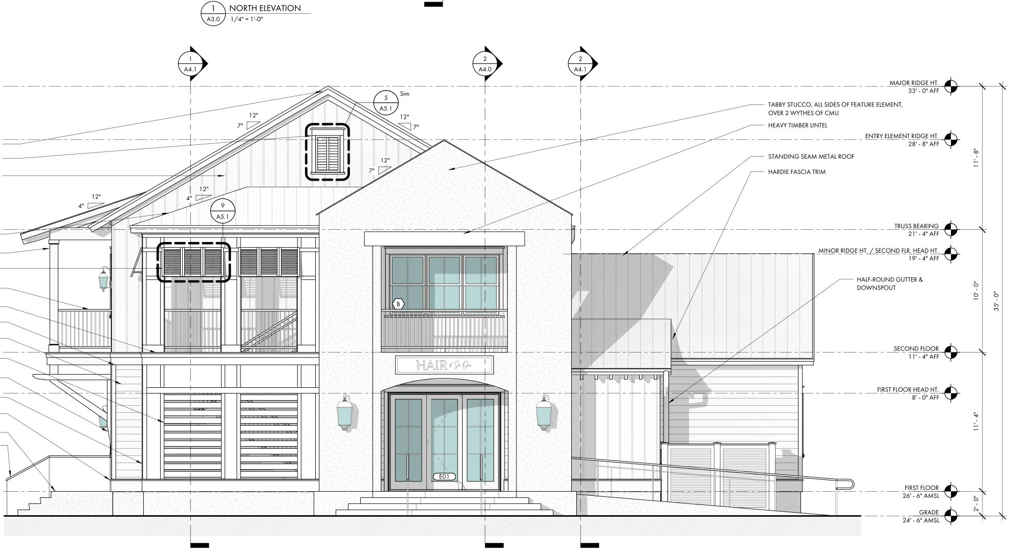
HARDIE FASCIA TRIM MECHANICAL LOUVER W/ HARDIE TRIM HARDIE BOARD & BATTEN SIDING
