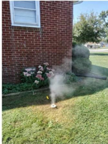
PS6-0020-MH to PS6-0019-MH: PVC cleanout with broken cap
